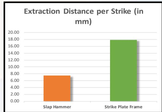
**Vergleiche zwischen der Effizienz des Schlagplattenrahmens und einem Standard-Schlaghammer.**
